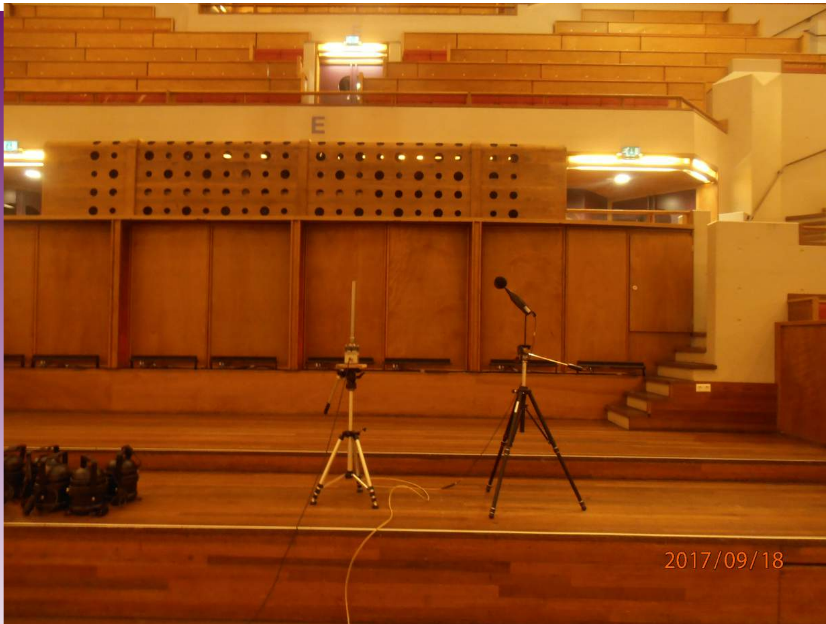
Meting met meetprogramma DIRAC 6: podiumakoestiek in Grote Zaal TivoliVredenburg Utrecht: stage support
